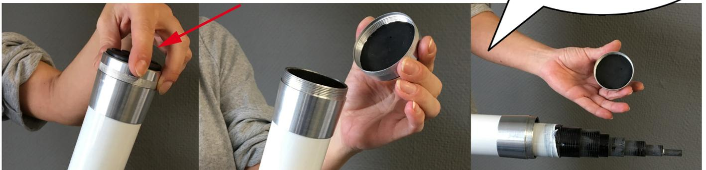
Durch das Abschrauben des **Aluminium Bodenverschluss** können **unten** die **einzelnen Rohre** entnommen werden, bitte schrittweise mit dem kleinsten Durchmesser beginnen. Hier können auch eventuell beschädigte Segmente entnommen und ausgetauscht werden.
